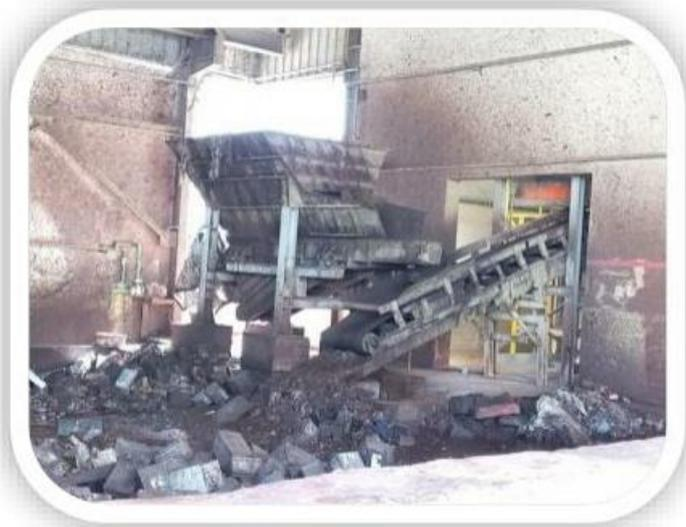
Figure13 : un réservoir vibrant
