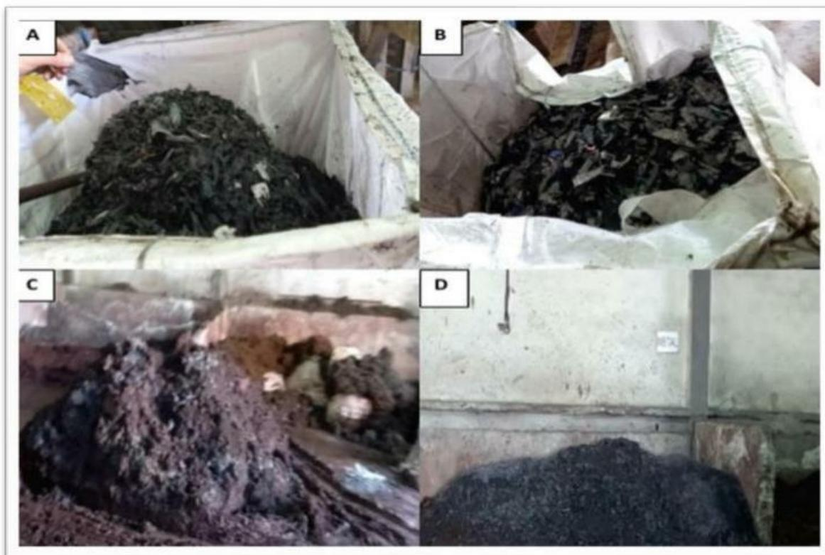
**Figure 18 : Produits fini de l'étape de Broyage :A) séparateur, B) polyéthylène (plastique ,boîte et couver de boîte) C) la pâte (oxyde plomb ) D) métal**
