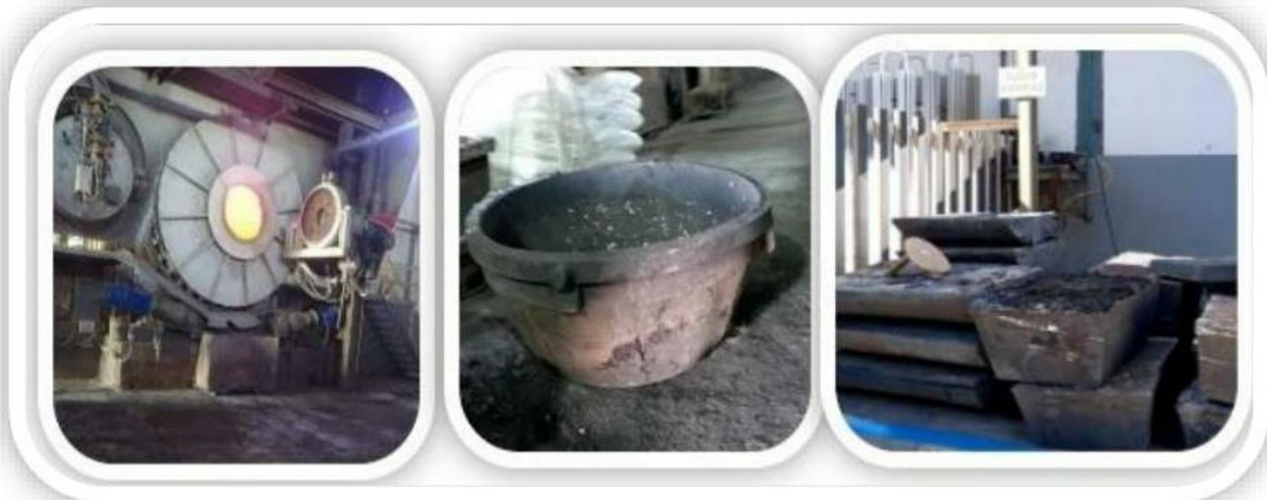
**Figure 20 : four rotatif****les poches de collés****plomb d'œuvre**
